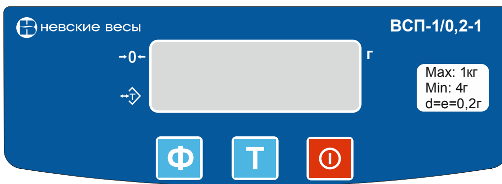
Рис.1. Лицевая панель весов ВСП-1
